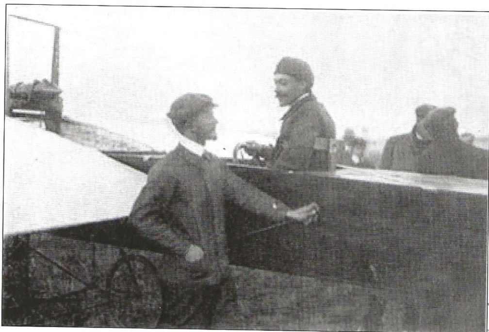
Alfred de Pischof s'entretenant avec Jean-Paul Koechlin assis au poste de pilotage. On remarque le dossier oscillant commandant le gauchissement (Arch. Musée de l'Art)
